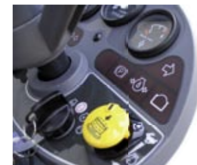
Lastschaltbare Zuschaltung der Zapfwelle. Inkl. Schnellstopfunktion
