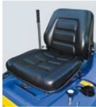
Alternativ zum serienmäßigen Sitz (links) erhöhen Sie Ihren Sitzkomfort durch den optional lieferbaren Deluxe-Sitz (rechts) mit zusätzlichen Einstellmöglichkeiten, höherer Rückenlehne und optimierter Passform.
