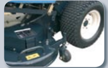
Laufrollen um 90° drehen und Schnellarretierungsbolzen werkzeuglos lösen.
