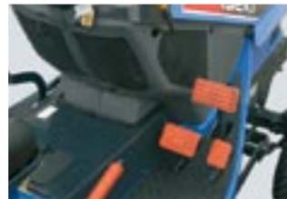
Stufenlose Bedienung des Fahrtriebs durch 2-Pedal-Steuerung.
