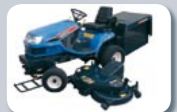
Lenkung einschlagen und Mähwerk am Griff anfassen und herausziehen.
