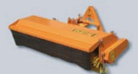
Frontkehrmaschine: 100/125 cm Arbeitsbreite, wahlweise mit Behälter
