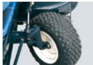
Hohe Wendigkeit durch großen Lenkeinschlagswinkel.
