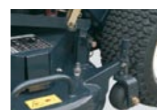
Für die tägliche Reinigung befinden sich rechts und links auf dem Mähwerk Schlauchanschlüsse.
