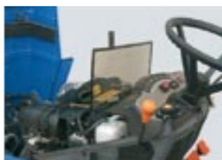
Das Kühlersieb ist werkzeuglos von oben zugänglich.
