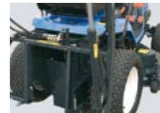
Die Reinigungsklappe wird vom Sitz aus betätigt, um den Kanal von Grasresten zu leeren.
