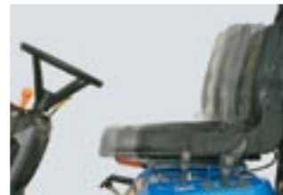
Der Fahrersitz ist mit Sicherheitskontaktschalter ausgerüstet und in Längsrichtung einstellbar.
