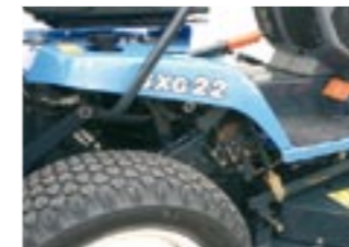
Der Handhebel für die Reinigungsklappe ist direkt neben dem Sitz angebracht.
