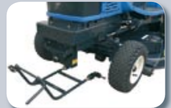
Zuggestänge entriegeln und mit Schnellarretierungsbolzen vom Mähwerk trennen. Hydraulik anheben.
