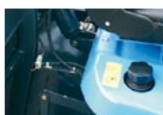
Die leicht zu betankende Kraftstofffüllung (21 Liter) reicht für einen normalen Arbeitstag im Einsatz.
