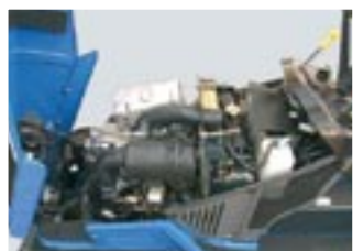
Einfacher Zugang zu den Wartungspunkten des Motors.
