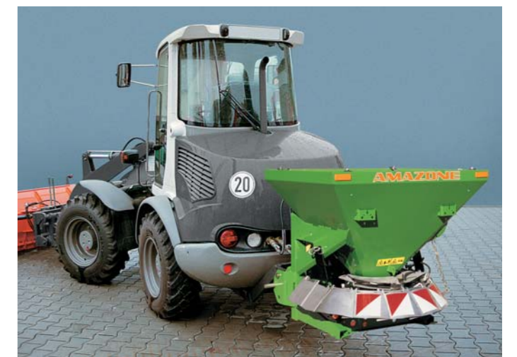
Der Antrieb mit Hydraulikmotor ermöglicht z.B. den Einsatz mit einem Radlader.
