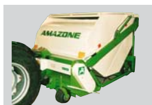
Grasmäher Grasshopper mit Behälter-Hochentleerung
